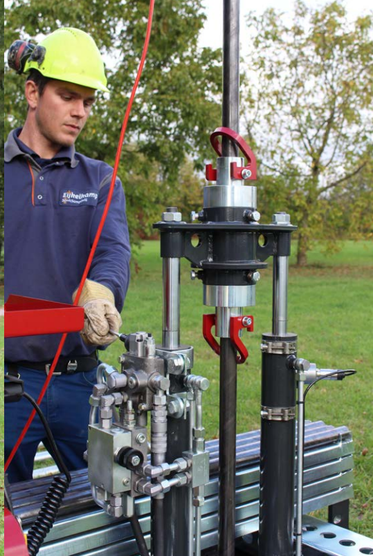
Koni Penetrasyon Testinin (CPT) yapılması
